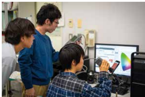
スマートフォン等画面の色度測定実験(学生実験室にて)。「色」には、心理面に様々な作用をもたらす効果があり、色情報を定量的にデータ化することで科学的検証や統計解析など学術的な研究に幅広く活用することができます。
