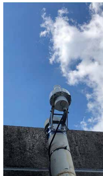
図1 長与町役場屋上の雨量センサー
