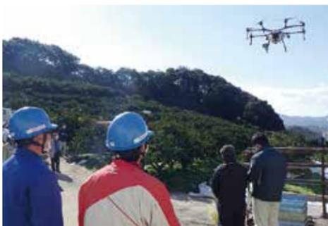
動力噴霧器などを使用した急傾斜地での柑橘防除は大変な作業です。柑橘防除の省力化を図るため、ドローン防除の実証試験を実施しています。令和3年度の試験結果では、10アール当たり数分で散布でき、病害虫の防除効果も従来と大差がないことがわかりました。散布できる登録農薬が少ないことが現在の課題ですが、ドローンの可能性について十分期待が持てる結果でした。現在、町農業後継者協議会が中心となって操縦資格を取得して実証試験に取り組んでおり、今後は地域の農家から防除を請け負う仕組みができないか検討中です。また、町では国の実証事業とは別に、水田でのドローン防除を推進するため、農業者へ操縦資格取得費の助成を行っています。詳しくはお問合せください。
